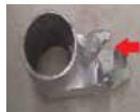
Kontrollera att fjädern och den del som låser gängan på det justerbara benet är hela.
