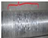
Skador på gängan på det justerbara benet
