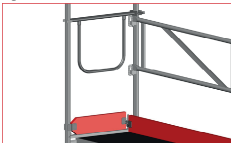
Fig. 2.17: Sikring med enderekker
