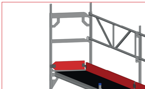
Fig. 2.20: Sikring av høyeste etg
